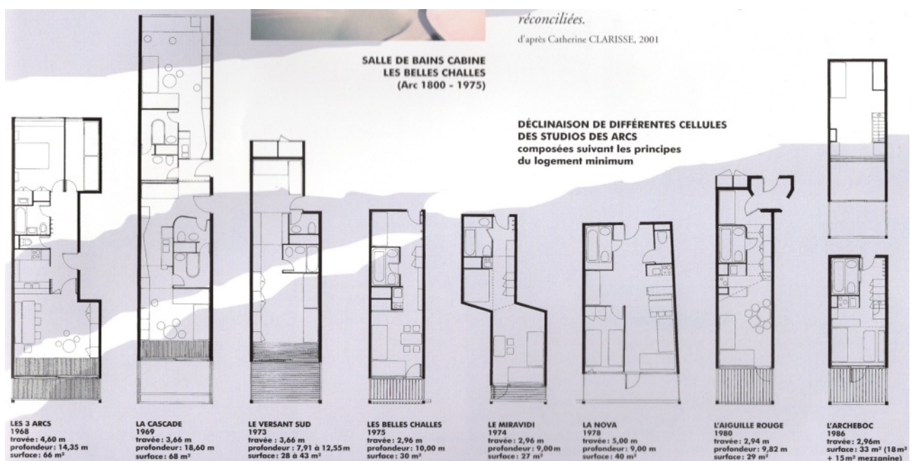
Fig. 34 : Déclinaison de différentes cellules des studios des Arcs, composées suivant les principes du logements minimum. Source : LYON-CAEN Jean-François dir., 2003, Montagnes, territoires d'invention, Seyssinet-Pariset, ENSAG
